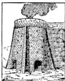
38. Quand on chauffe du calcaire dans un four, ce calcaire devient de la chaux .
